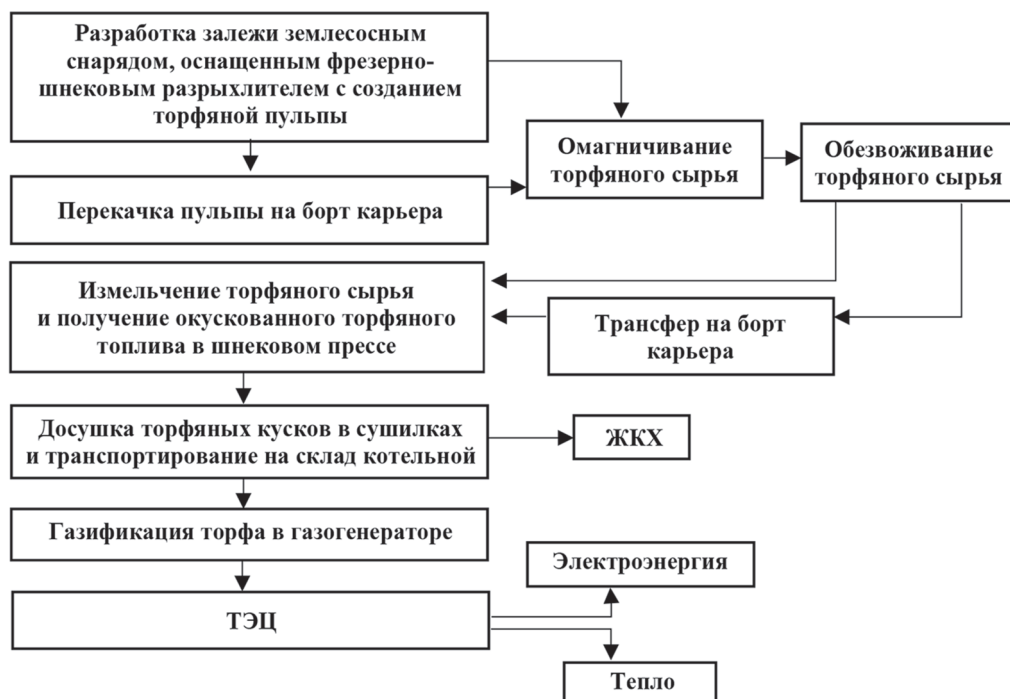
Рис. 3. Технологическая схема добычи и переработки торфяного сырья предлагаемой гидромеханизированной технологии для получения генераторного газа [составлено авторами]
