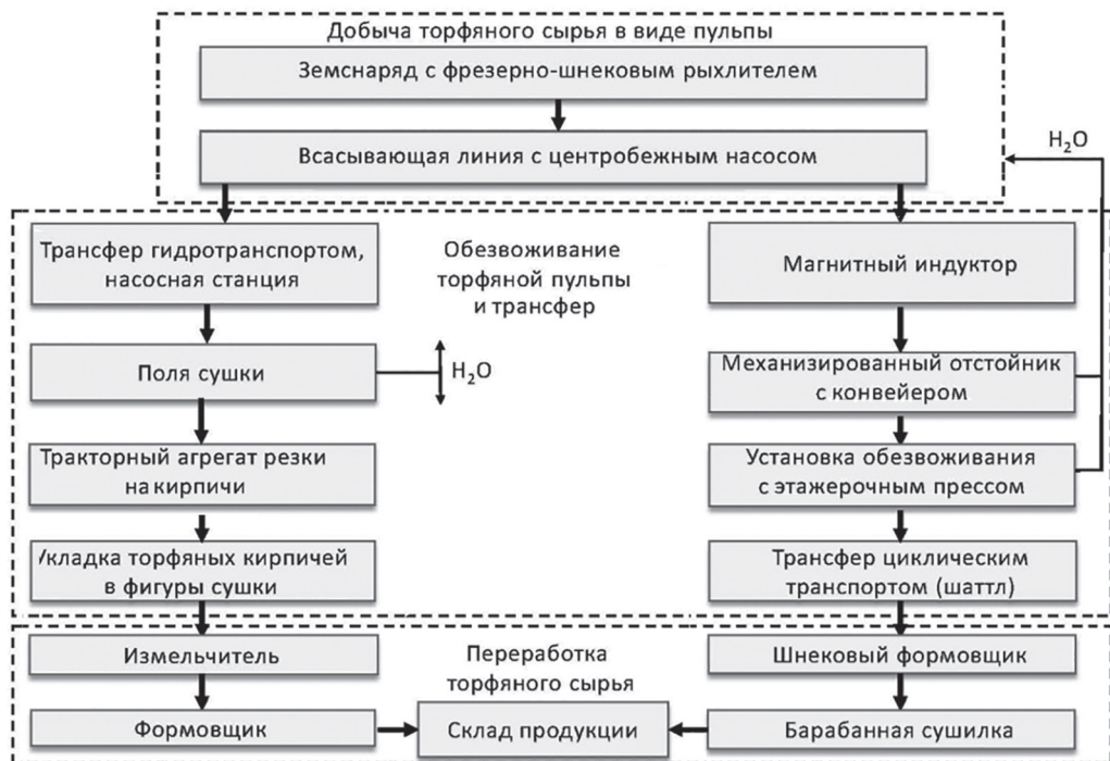
Рис. 1. Оборудование для существующей гидромеханизированной и предлагаемой технологий добычи и переработки торфяного сырья [составлено авторами]
