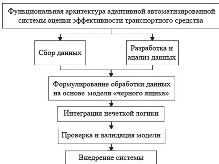
Рис. 1. Функциональная архитектура адаптивной автоматизированной системы оценки эффективности горных машин [составлено авторами]
