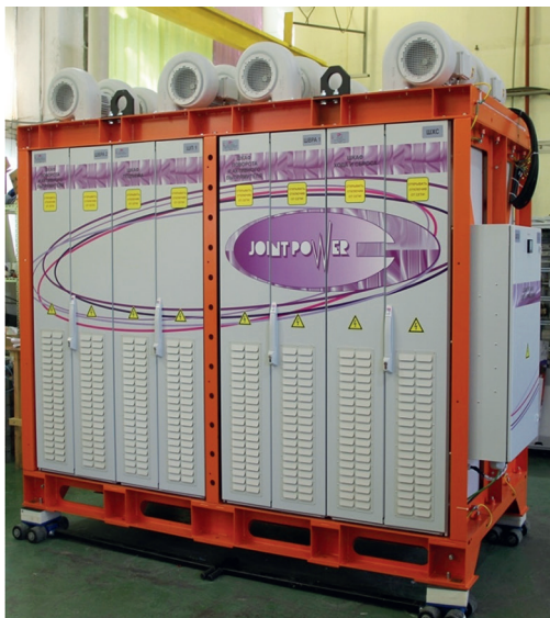
Рис. 1. Шкафы управления приводами экскаватора ЭКГ-20 Fig. 1. Control cabinets for the EKG-20 excavator drives
