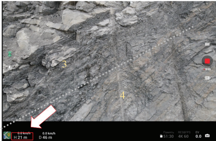
Рис. 3. Точка наблюдения на глубине 9 метров (высотной отметке +111 относительно нулевой отметки запуска +90 и прироста по высоте относительно точки запуска +21 м) при идентификации раздела песчаник/алевролит [составлено авторами] Fig. 3. Observation point at a depth of 9 meters (elevation mark +111 relative to the zero launch mark +90 and an increase in height relative to the launch point +21 m) during identification of the sandstone/siltstone section
