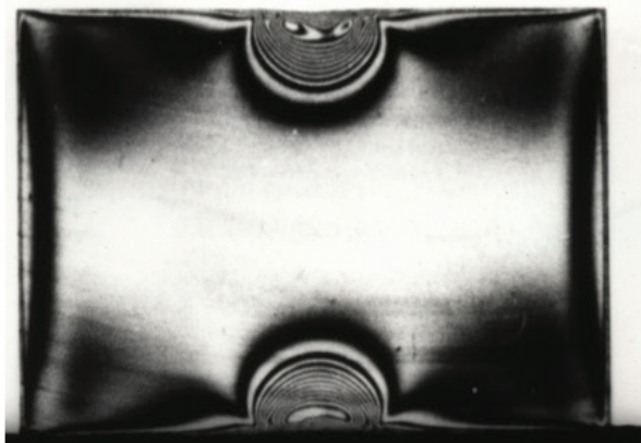
Рис. 1. Испытание образца эпоксидной смолы сферическими инденторами: а – схема испытания; б – распределение напряжений в образце [составлено авторами]:
