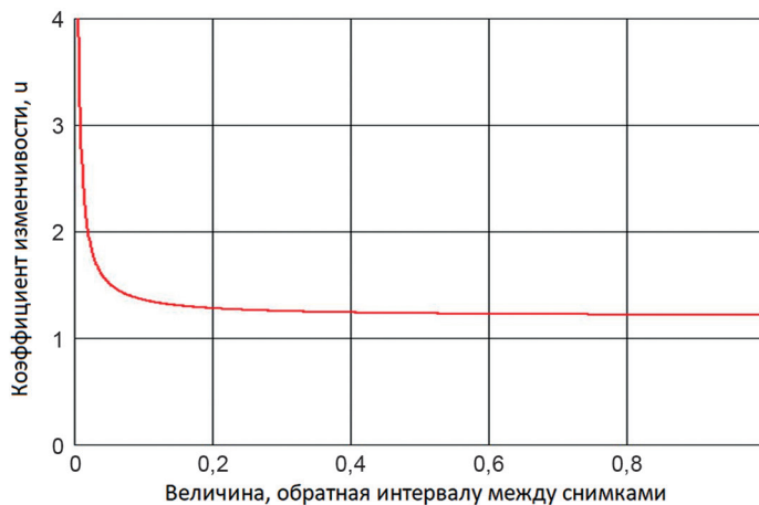
Рис. 7. График определения оптимального интервала съемки [составлено авторами] Fig. 7. Graph for determining the optimal remote sensing interval [compiled by the authors]
