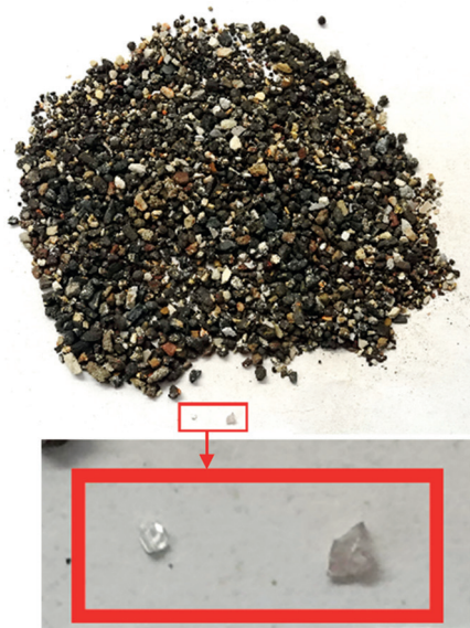
Рис. 7. Визуальное наблюдение алмазного кристалла в немагнитном продукте второй контрольной стадии опытной схемы магнитной сепарации Fig. 7. Visual observation of a diamond crystal in the non-magnetic product of the second control stage of the experimental scheme of magnetic separation
