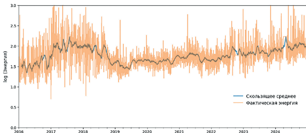
Рис. 3. Обработка энергии сейсмических событий методом скользящего среднего Fig. 3. Processing of seismic event energy using the moving average method
