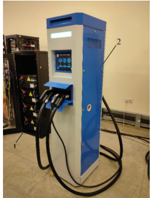
Рис. 2. Внешний вид ЭСЗ с АСНЭ: 1 — блок аккумуляторных батарей (накопитель), 2 — электростанция для карьерных самосвалов в сборе
