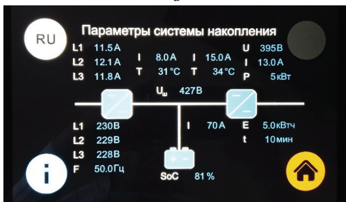
Рис. 1. Структурная схема ЭСЗ с АСНЭ (а) и действующий макет панели оператора HMI (б) Fig. 1. Structural diagram of the ESS with ACNE (a) and working mock-up of the HMI operator panel (b)
