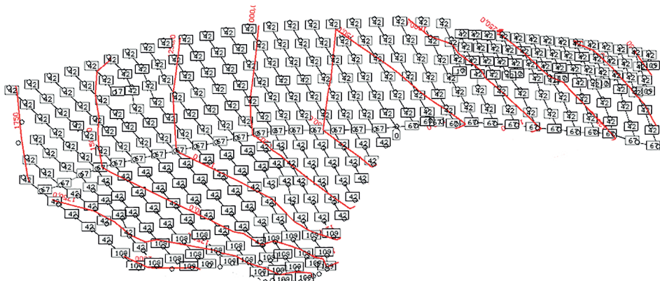
Рис. 3. Схема монтажа взрывной сети с изохронами инициирования блока № 1 Fig. 3. Initiation patterns with isochrons of initiation of block No. 1
