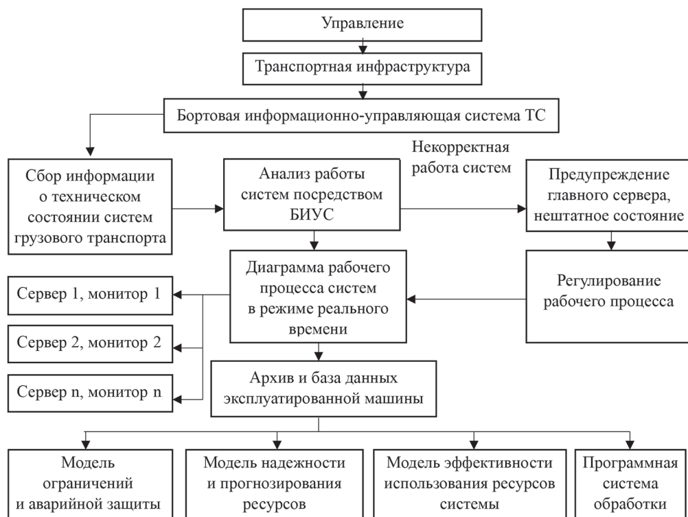
Рис. 1. Алгоритм сбора и обработки информации, получаемой с бортовых информационно-управляющих систем карьерных экскаваторов [составлено авторами]
