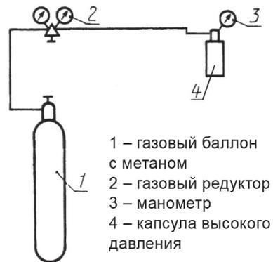
Рис. 1. Схема экспериментальной установки [составлена авторами]
