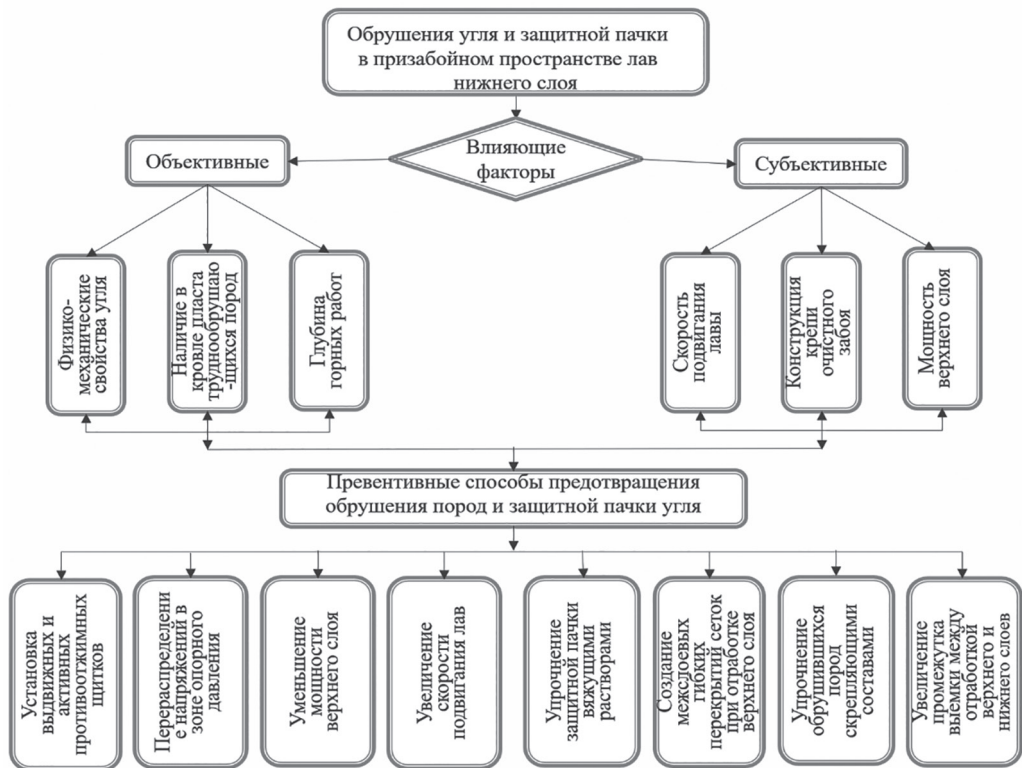
Рис. 2. Способы предотвращения обрушений межслоевых защитных пачек и пород кровли в призабойное пространство лав надрабатываемых слоев
