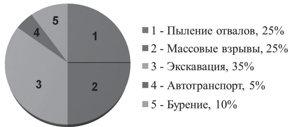
Рис. 2. Структура выбросов пыли по различным технологическим процессам [составлено авторами] Fig. 2. The structure of dust emissions by various technological processes [compiled by the authors]
