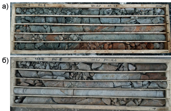
Рис. 2. Геологическое строение массива на экспериментальном участке № 1: метаморфизированные туфы (замерная станция № 1) (а); известняк (замерная станция № 2 и 3) (б)
