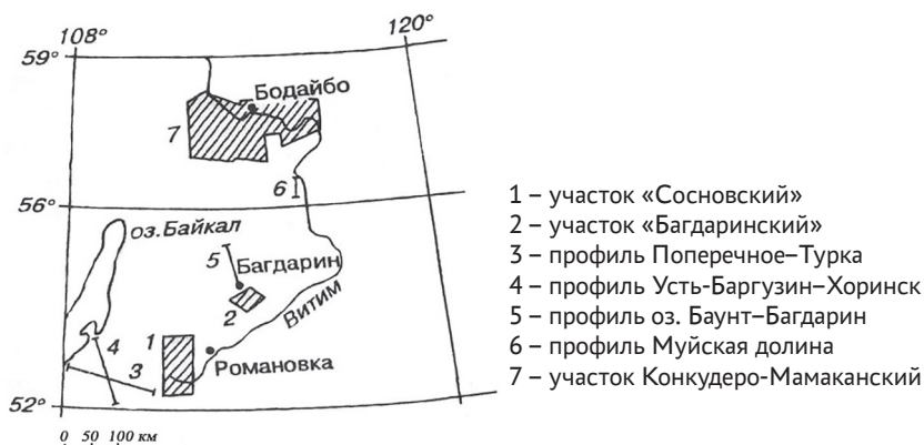
Рис. 1. Схема аэроэлектроразведочных работ на самолете АН-2
