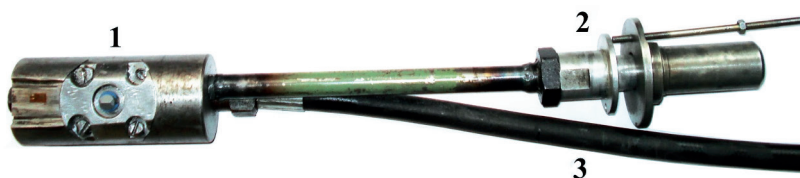
Рис. 1. Лабораторная версия устройства «Прочностномер ПСШ-1» Fig. 1. Laboratory version of the device «Strength meter PSSH-1»
