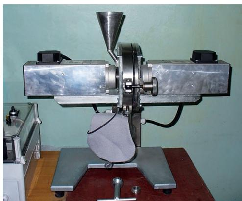
Рис. 1. Дезинтегратор для механохимической активации выщелачивания металлов
