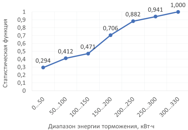
Рис. 3. Статистическая обработка значений энергии за один акт торможения: а – распределение вероятности; б – статистическая функция Fig. 3. Statistical processing of braking energy: a – probability distribution; b – statistical function
