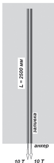
Рис. 2. Постановка задачи для определения нагруженности анкеров
