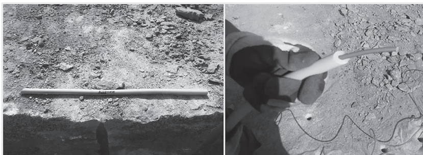
Рис. 3. Заряд эластичный трубчатый «Гранилен-1» (внешний вид)
