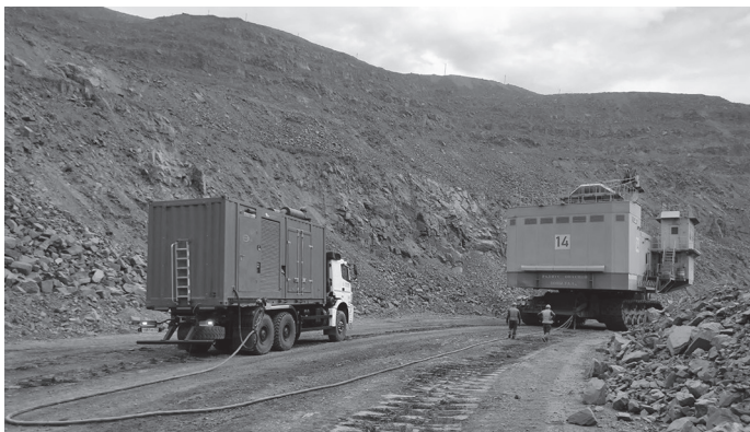
Рис. 7. Перегон экскаватора ЭКГ-20 на Лебединском ГОКе
