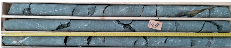
Рис. 5. Залеченные трещины карбонат-кварцевым материалом Fig. 5. Healed cracks with carbonate-quartz material
