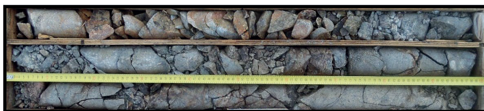
Рис. 8. Зона ослабления, представленная щебнем Fig. 8. The weakening zone represented by rubble
