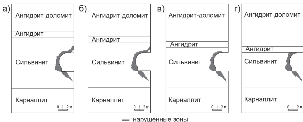
Рис. 4. Формирование нарушенных зон в зависимости от мощности буферного слоя в кровле выработки: 3,0 м (а); 2,0 м (б); 1,0 м (в); 0 м (г)
