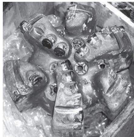
Рис. 1. Разрушение PDC долота в режиме Stick-Slip эффекта
