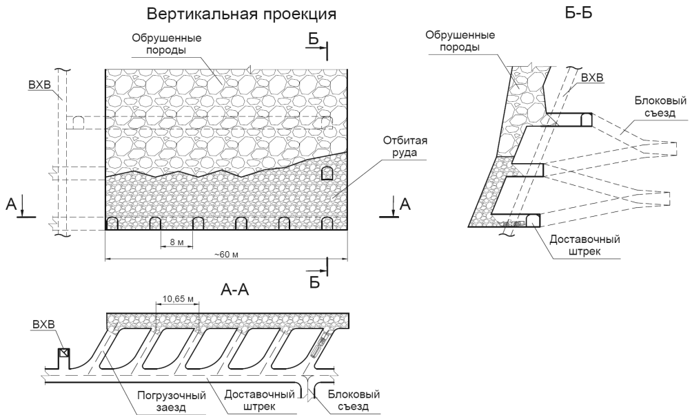
Рис. 3. Площадной выпуск руды МЭЦ и МКЦ под обрушенными породами вышележащего блока и висячего бока Fig. 3. Level and rib pillars areal ore drawing under the caved rocks of the overlying block and hanging side
