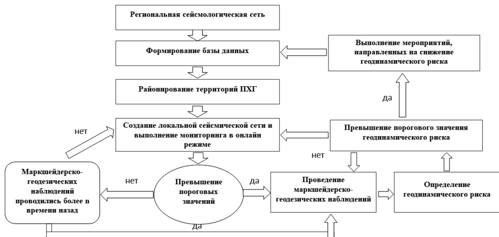
Рис. 3. Блок-схема системы геодинамического мониторинга Fig. 3. Block diagram of the geodynamic monitoring system
