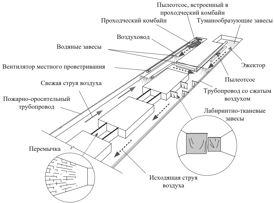
Рис. 1. Схема размещения комплекса мероприятий по снижению уровня запыленности рудничной атмосферы
