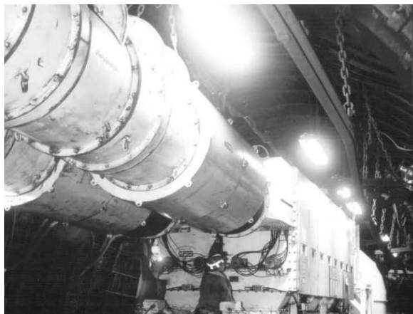
Рис. 3. Система сухого обеспыливания компании CFT (фотография и принципиальная схема работы)
