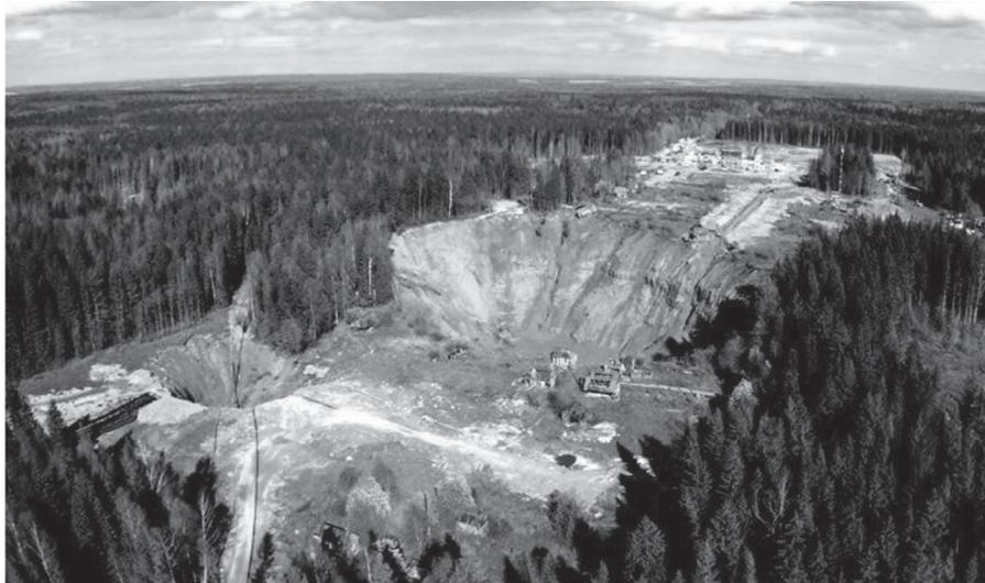
Рис. 1. Провалы земной поверхности над шахтным полем СКРУ-2
