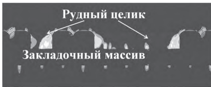
Рис. 8. Зоны предельного равновесия массива рыхлой руды после проведения выработок 1 слоя
