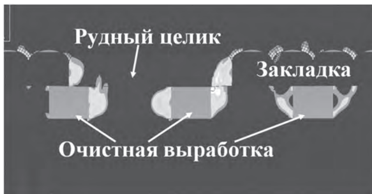
Рис. 7. Зоны предельного равновесия массива рыхлой руды после проведения выработок первой очереди 1 слоя.
