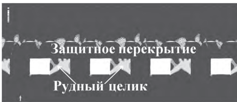
Рис. 5. Формирование зон предельного равновесия после проведения вприсечку выработок второй очереди 1 слоя
