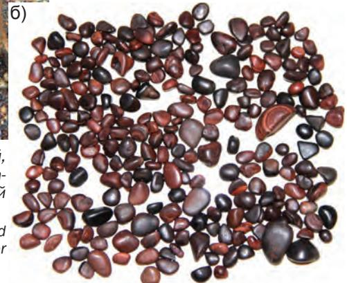
Рис. 2. Отсадочная установка с тяжелой фракцией, содержащей золото и деревянистое олово (а), галечки деревянистого олова, 1–2,5 см по длинной оси (б)
