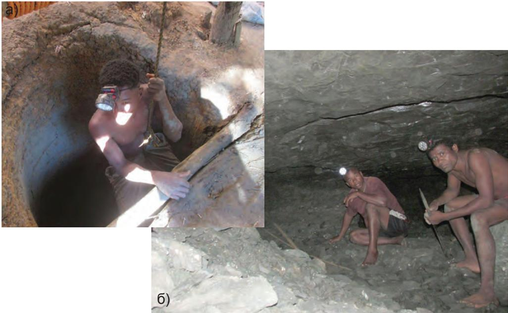
Рис. 1. Спуск рабочего в шурф (а) и рабочие в забое шурфа (б)
