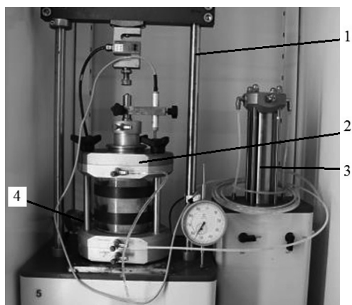
Рис. 1. Общий вид установки трехосного сжатия испытательного комплекса «АСИС-2»
