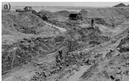
Рис. 3. Карьер месторождения фоссилицированных известняков (а). Стенка карьера: 1 — маломощный пролювиальный слой; 2 — смещенный элювий известняка; 3 — структурный элювий известняка. Граница слоя 2 и 3 указаны автором (б)
