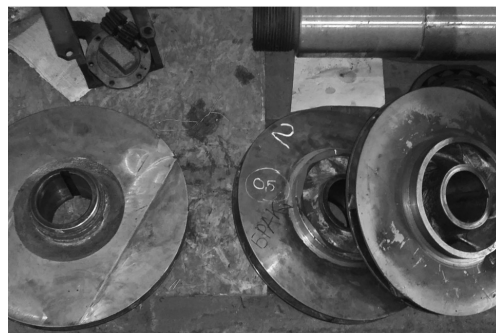
Рис. 1. Дефекты рабочих колес насоса ЦНСк 400-660
