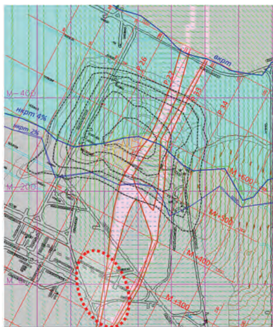
Рис. 9. Вектора максимальной компоненты главных напряжений на горизонте +170 м
