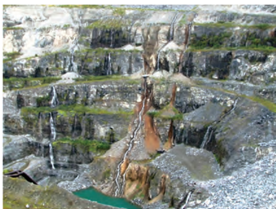
Рис. 1. Выход Саамского разлома в карьерное пространство
