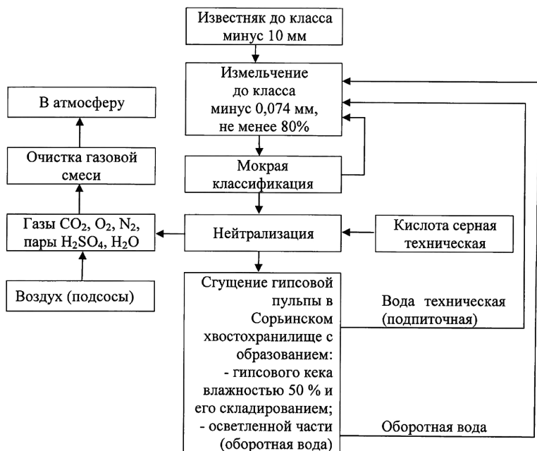
Рис. 2. Блок-схема процесса нейтрализации серной кислоты природным известняком
