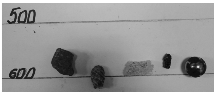
Рис. 5. Момент полета частиц горной породы на отметке — 600 мм (слева направо: халькопирит, кварц, асбест, уголь, стальной шар)
