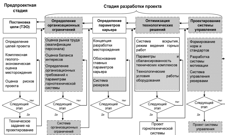
Рис. 1. Последовательность проектирования высокопроизводительных горнотехнических систем карьеров
