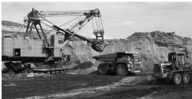
Рис. 1. Погрузка вскрышных пород в автомобильный транспорт
