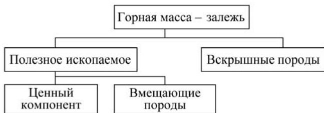
Рис. 2. Структурная модель комплекса горных пород, образующих горную массу в месторождении рудного полезного ископаемого
