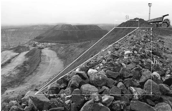
Рис. 2. Разгрузка мелкодисперсных отсеvов с линии ЦПТ и распределение их на откосе отвала
