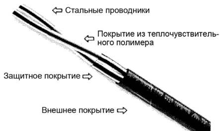
Рис. 1. Конструкция термокабеля PHSC
