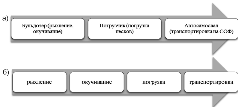
Рис. 1. Технологическая схема с автосамосвалом: а) цепочка машин, б) стадии технологической схемы
