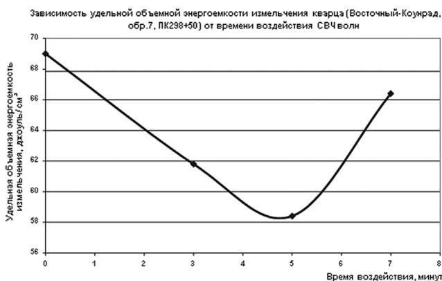
**Рис. 4. Зависимость энергоёмкости измельчения от времени воздействия СВЧ волн (кварц)**
