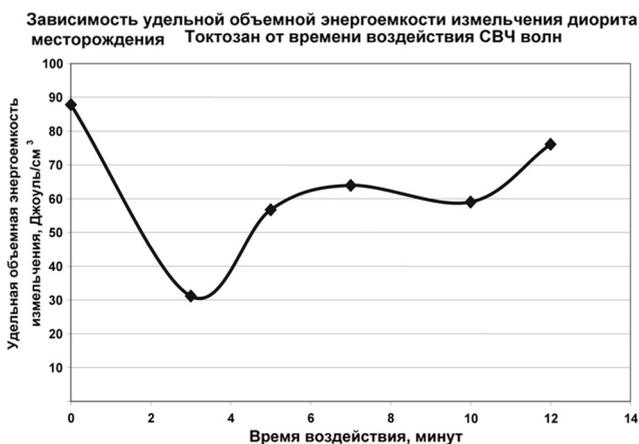
**Рис. 2. Зависимость энергоёмкости измельчения от времени воздействия СВЧ волн (диорит)**
