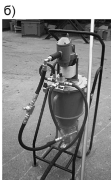
Рис. 6. Оборудование вспомогательного назначения: а) установка для чистки и смазки канатов ЧК-М; б) нагнетатель НПШ-1
