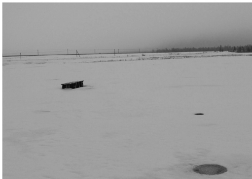
Рис. 2. Процесс акустической дегазации воды на акватории водозабора через не замерзающие полыньи: а) понтон с излучателем б) полынья с газовыми пузырьками
