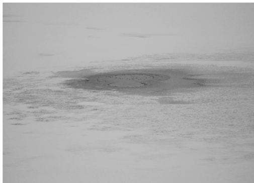
Рис. 2. Процесс акустической дегазации воды на акватории водозабора через не замерзающие полыньи: а) понтон с излучателем б) полынья с газовыми пузырьками
