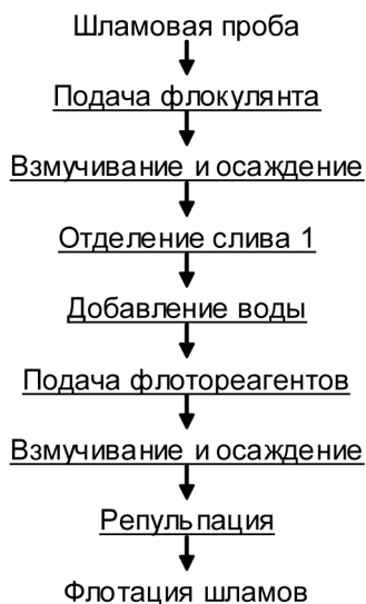
Рис. 2. Последовательность операций комбинированного опыта по сгущению и флотации шламов
