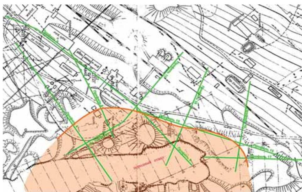
*Рис. 7. Диагностика геомеханического состояния приконтурного массива зоны обрушения в районе шахты*
