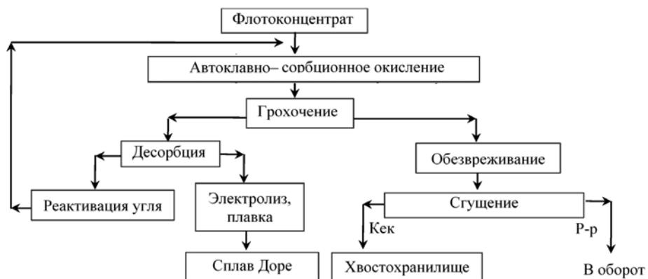
**Рис. 5. Технологическая схема переработки упорного золотосульфидного концентрата**
