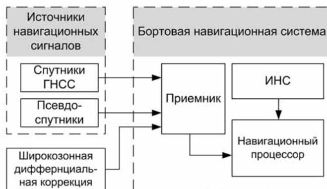
Структурная схема карьерного навигационного комплекса
